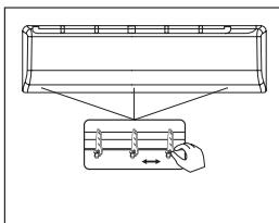
Акуратно поверніть основну пластину жалюзі при вимкненому кондиціонері вниз, щоб побачити вертикальні напрямляючі (жалюзі), що виконані з прозорої пластмаси.
